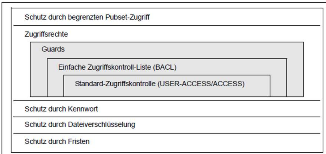
Bild 6: Schutzmechanismen für Dateien auf einem Pubset
