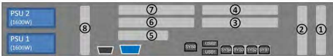
Bild 5: AU47 M5 - Prinzip der PCIe-Slot-Belegung auf der Geräterückseite
